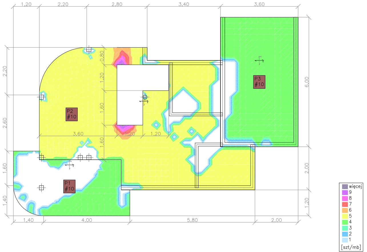
Zbrojenie dolne - kierunek 2 [szt/mb]
